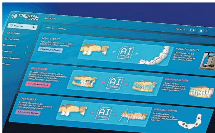
So sieht die „Dental-Twin“-Software aus, die mittels KI vollautomatisch Zahnersatz in allen Formen und Größen generiert. Foto: Dental-Twin
