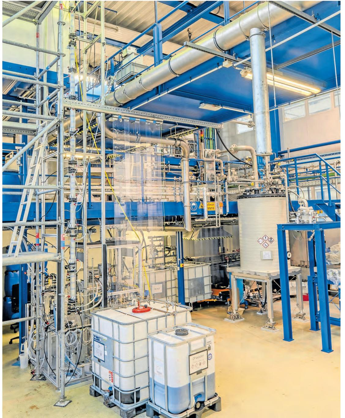
Blick auf die innovative Kolonnentechnologie, die H.C. Starck Tungsten für das Schwarzmasse-Recycling entwickelt hat. Foto: H.C. Starck
