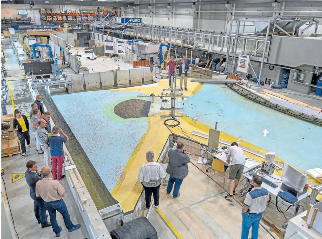
Um die Wirkungsweise des Hochwasser-Rückhaltebeckens zu demonstrieren, starteten die Ingenieure das Vorgängermodell einer Anlage, die zwischen Riesa und Torgau gebaut wird. Im Hintergrund ist das Modell der Straßberger Anlage zu sehen. Fotos: Frank Drechsler
