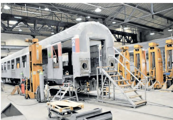
Bei der Sanierung werden die Waggons zunächst vollständig entkernt.
