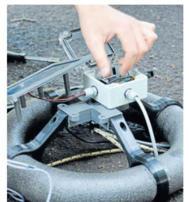
So sieht der Prototyp der Hydroguard-Messstation aus.
