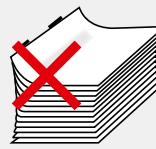
Papier zu dünn – Klammerung trägt auf
