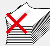
Papier zu dünn – Klammerung trägt auf
