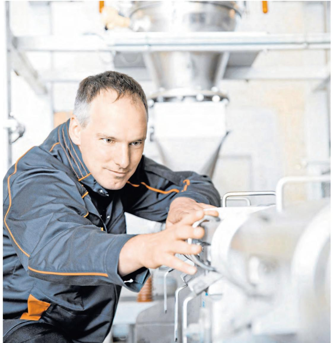
Produktion bei Oker-Chemie: Mitarbeiter Swen Weißhaupt behält die Dosierrinne für Silica-Gel im Blick. Sie regelt die Zufuhr des Trockenmittels auf ein Sieb. Zugleich werden metallische Verunreinigungen und Stäube entfernt. Foto: Oker-Chemie
