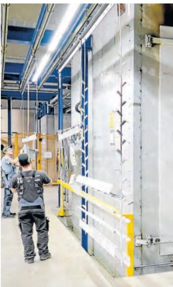
Mitarbeiter tragen Beschichtungspulver auf Werkstücke elektrostatisch auf. Danach kommen die bearbeiteten Stücke in einen etwa 180 Grad heißen Öfen, damit sich die Beschichtung bildet.
