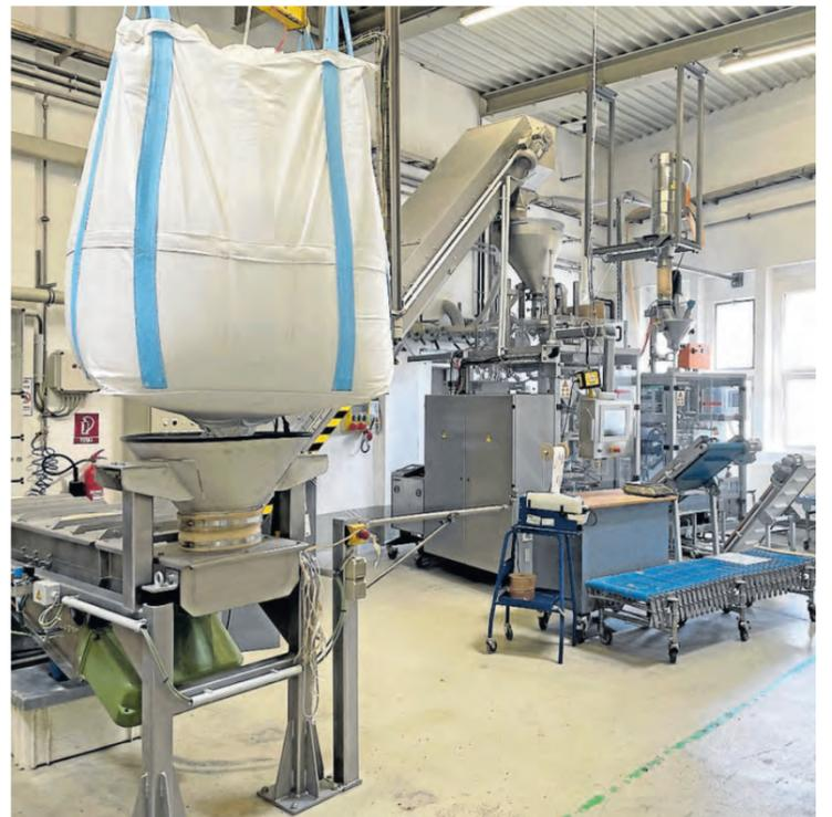
Blick in die Produktionsanlagen der Oker-Chemie: Das Foto zeigt eine Schlauchbeutelmaschine für Trockenmittel. Foto: Oker-Chemie
