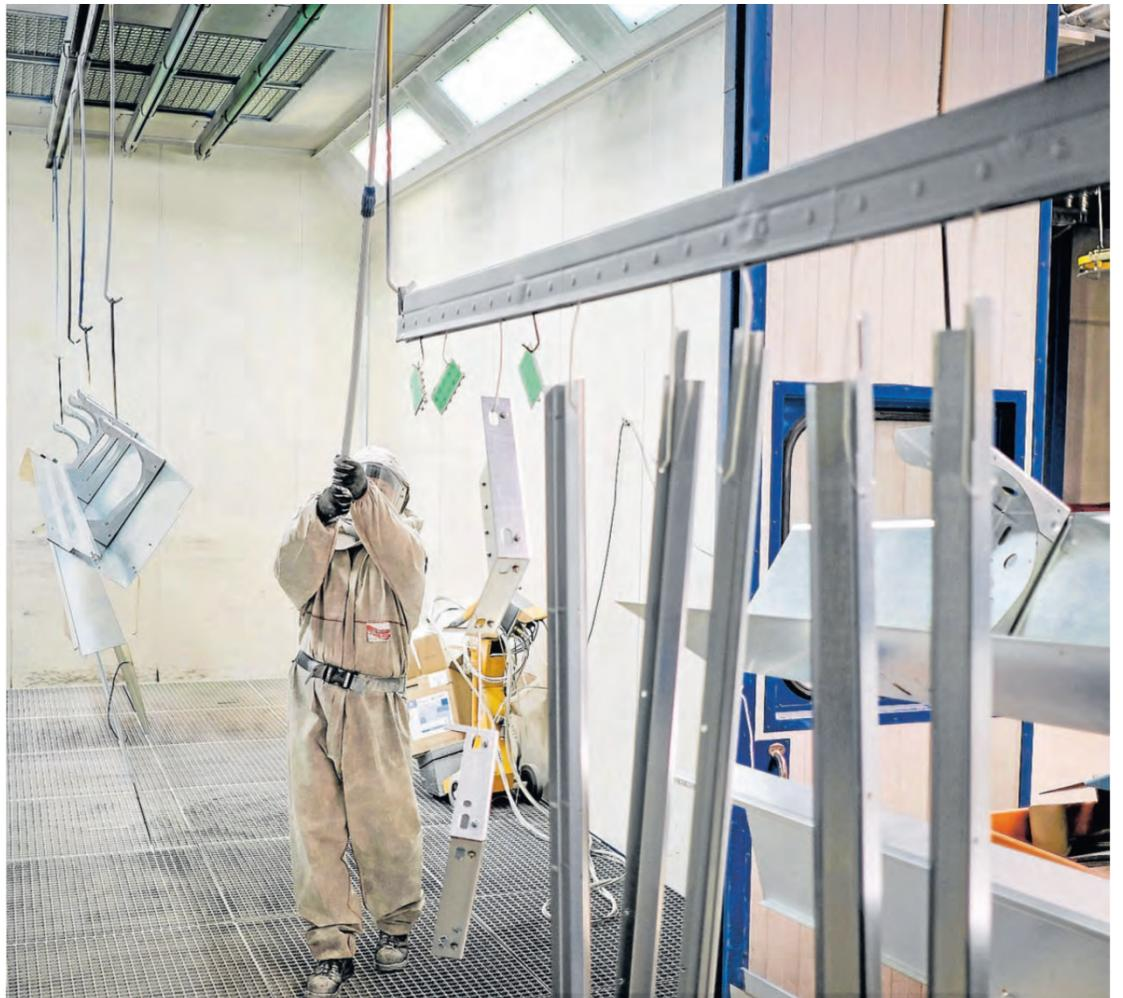
Die Firma Harzer Metallprofile ist in der Lage, auf kurzen Wegen ein- und mehrschichtigen Lackaufbau zu realisieren. „Wir können damit Werkstücke aus Aluminium, Stahl und verzinktem Stahl vorbehandeln“, erklärt Carsten Sturm.
